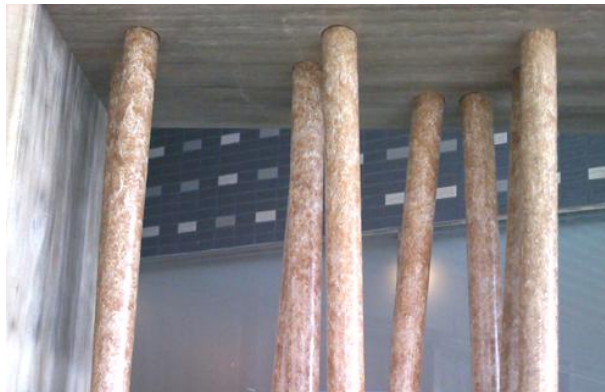
今回製造した間伐材 70%の新木材の押しだし棒
